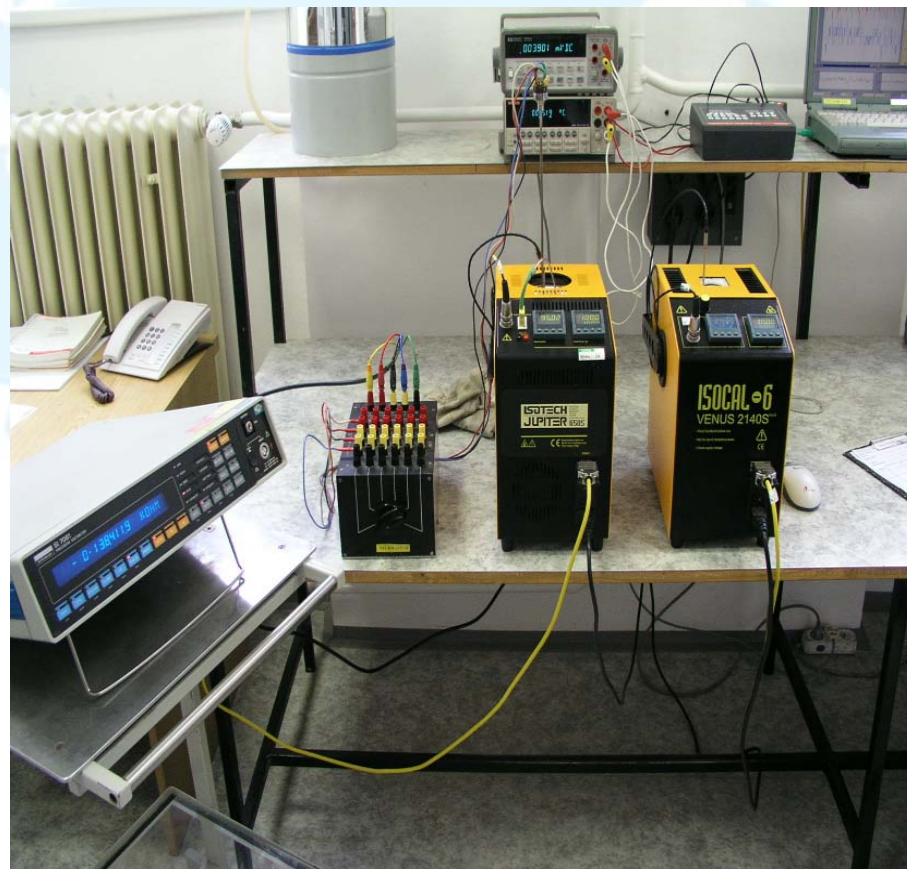
Kalibrace teploměrů v blokových pecích
